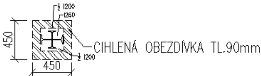
Obr. 7 Dimenze nosných ocelových konstrukcí 1. NP nad částí „Přístavek“
